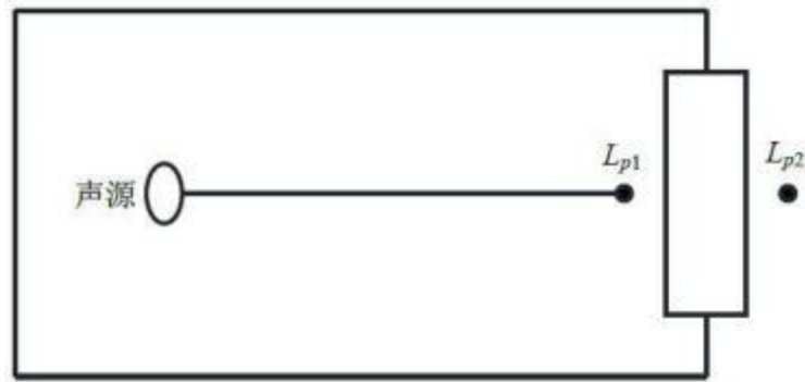
图5.2-6室内声源等效为室外声源图例
